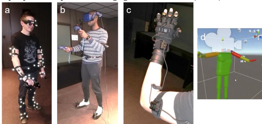
Figure 1 : Photographies des différents moyens d'expérimentation utilisés au cours du TP : a) Suivi Caméra ART. b) Vive Trackers. c) Centrales inertielles. d) Visualisation en temps réel du confort de la posture.
